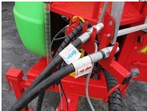
Rysunek 2. Przewody hydrauliczne umocowane prawidłowo.
