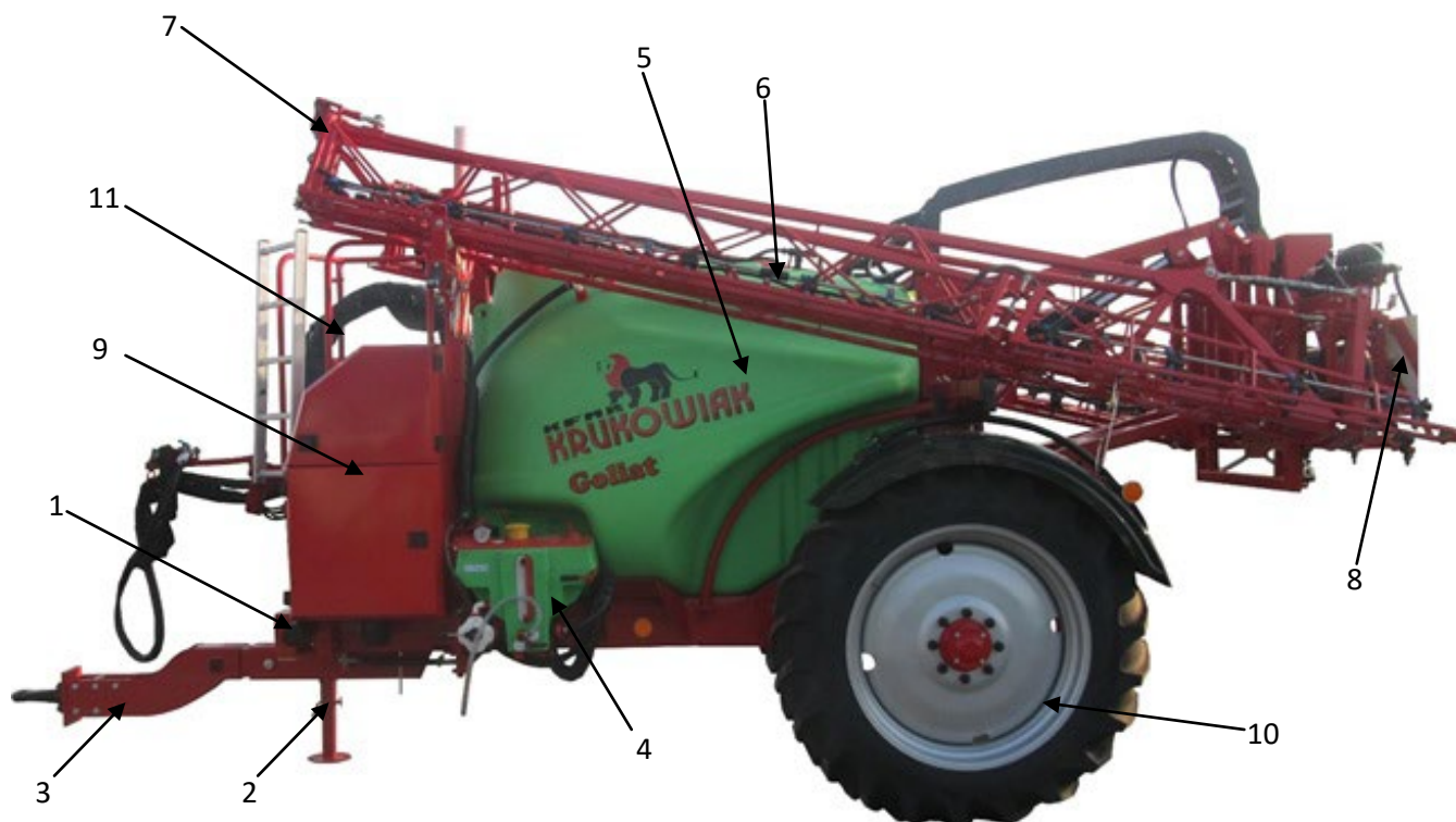
Rysunek 8. Budowa opryskiwaczy GOLIAT 2500/3000/3600/4200 PHN.
