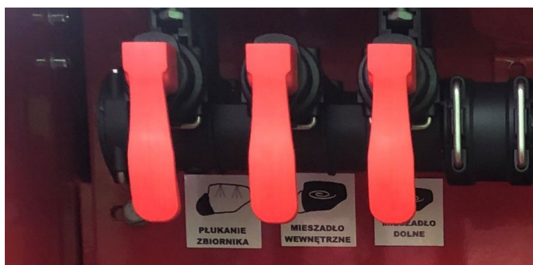
Rysunek 13. Manualne zawory sekcyjne.
